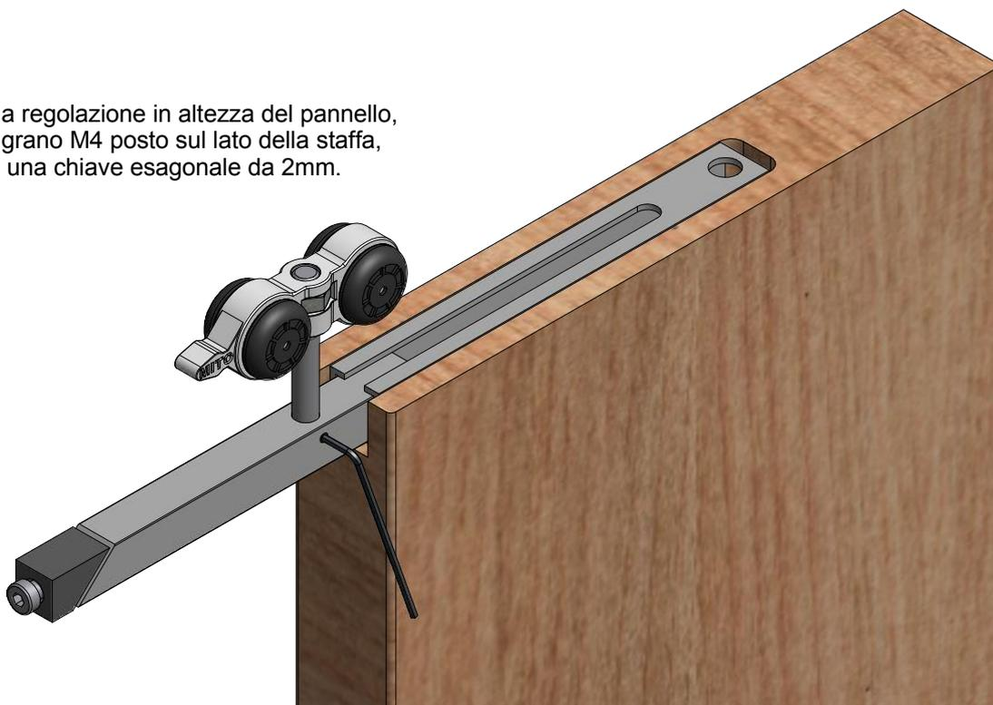
Ora inserire la staffa fino a fine corsa, mediante una chiave esagonale da 4mm, serrare la vite forntale per il bloccaggio della stessa.
