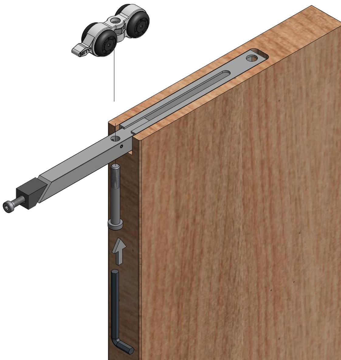
inserire parzialmente la staffa nel supporto, lasciando libero il foro su cui inerire la vite M8x60, mediante l'utilizzo di una chiave esagonale da 6mm, avviare la stessa nel carrello, precedentemente inserito nella guida di scorrimento del controtelaio.
