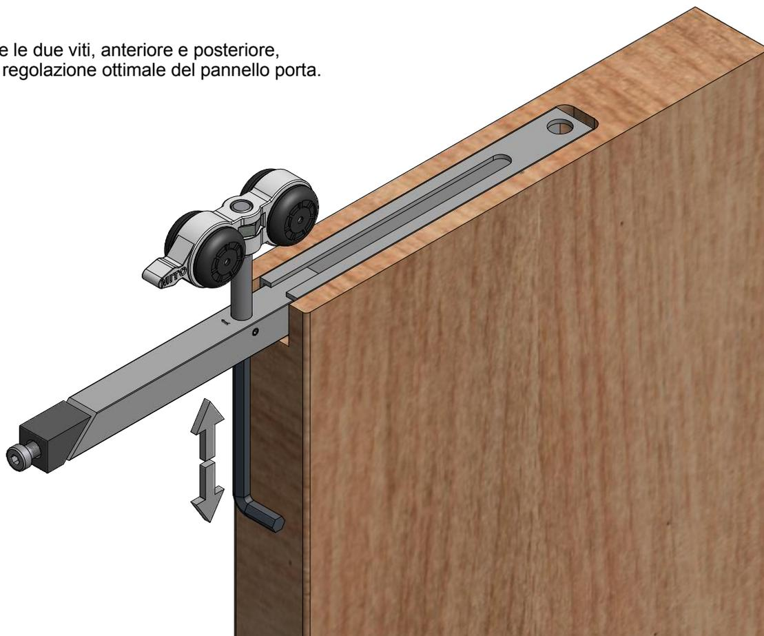
Ultimata la regolazione in altezza del pannello, serrare il grano M4 posto sul lato della staffa, mediante una chiave esagonale da 2mm.
